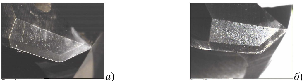
Рисунок 1.5 - Режущая кромка сверла Sandvik Coromant PT 86 нового (а) и изношенного после сверления 100 отверстий в смешанном пакете ВПКМ/Ti (б) [24]: n =
