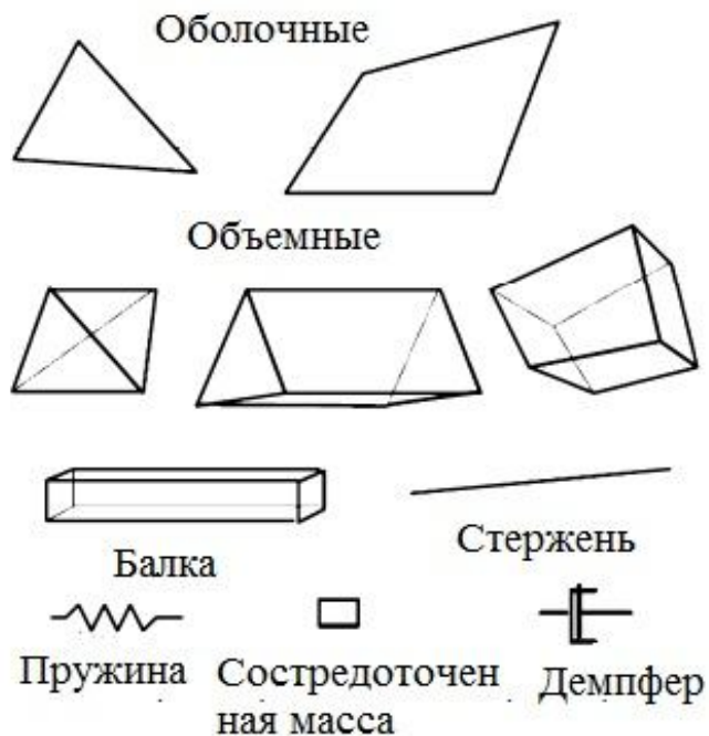
Рисунок 3.10 - Конечные элементы реализованные в программе LS- DYNA
