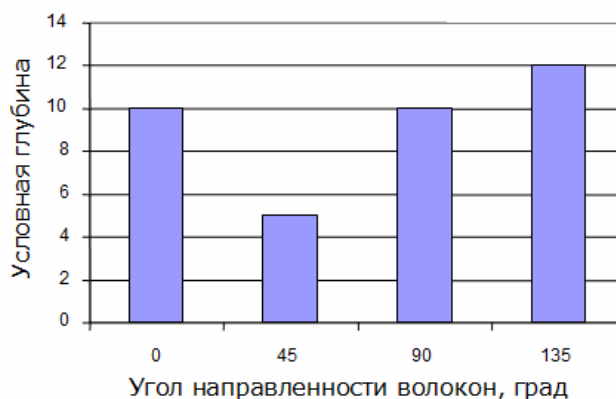
Рисунок 4.8 – График зависимости условных повреждений от угла направленности волокон \theta^\circ
